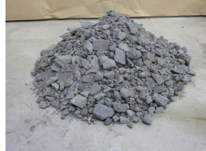
再生路盤材(RCB-40)
