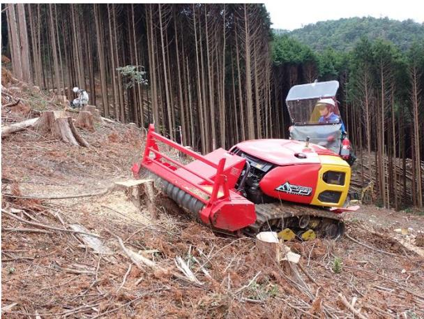
図1 多目的造林機械（根株処理）
