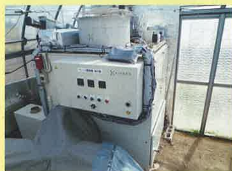
開発中の小型木質ペレット加温機
