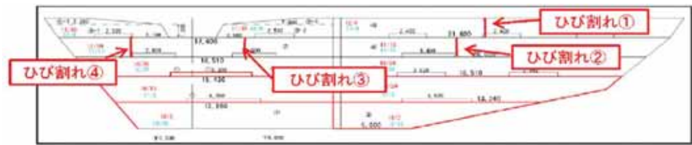
ひび割れ発生箇所
