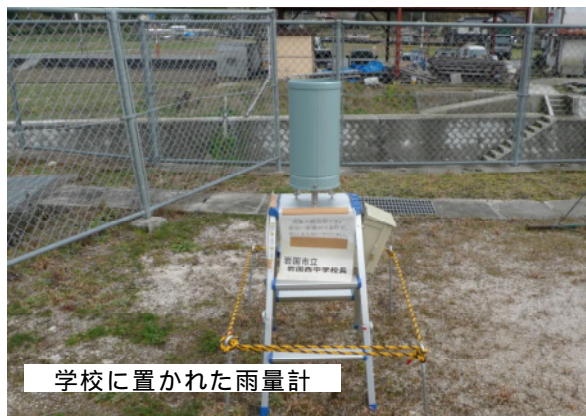
岩国市内の小中学校に設置した雨量計(6ヶ所)
