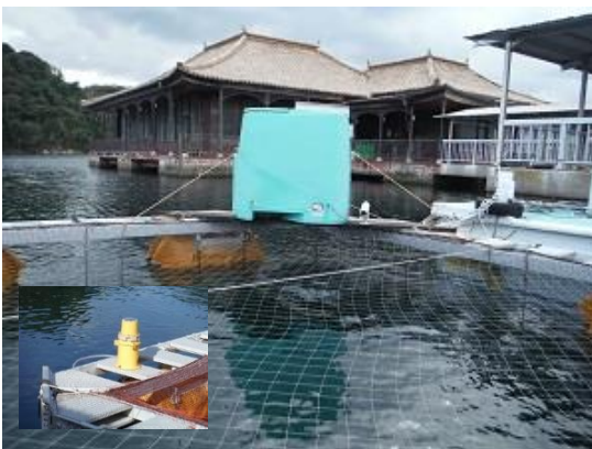
各種センサ、自動給餌機、カメラ、通信機器を設置した養殖いかだ
