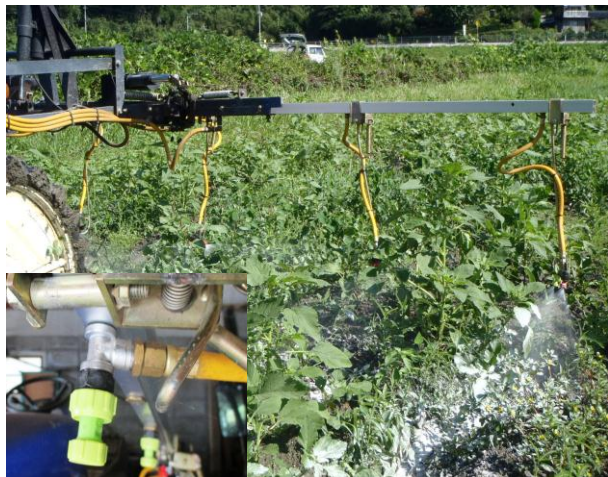
図3 除草剤散布ノズルの取り付け 畝幅に合わせて取り付け位置を調整
