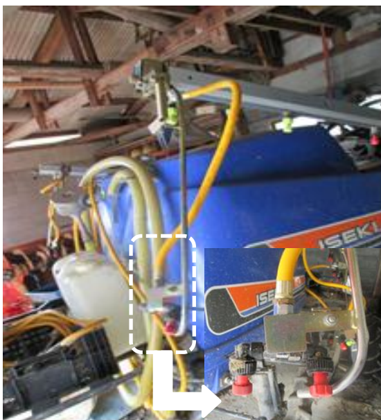
図1 防除用ノズルと霧なしノズル 先端のノズルを霧なしノズルに交換
