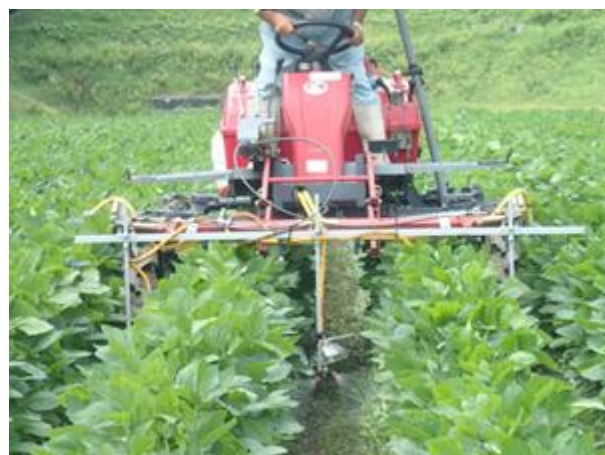
図5 クボタ社ハイクリブームと専用ノズルの取り付け
