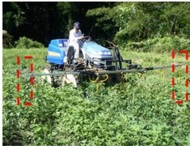
図4 除草剤散布ノズルの取り付け本数 両端は目視できないため作業精度が低下
