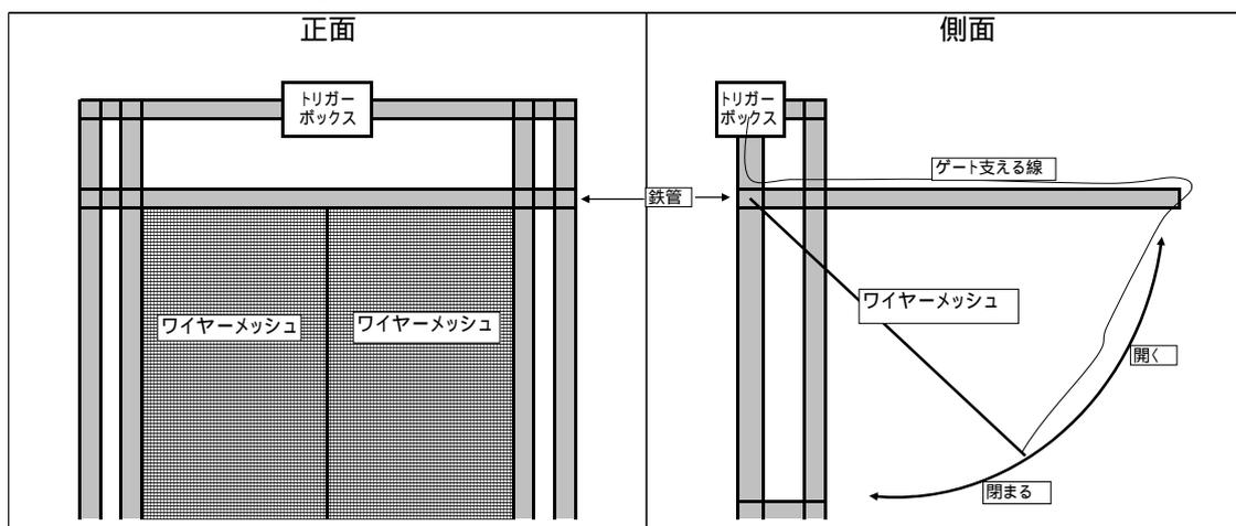
図 4 - 2 ゲートの構造
