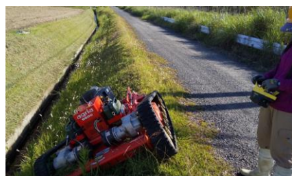
写真1 リモコン式除草機(A社製)
