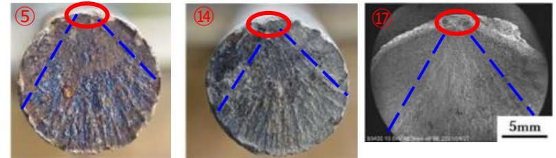
今回確認した破断面の観察結果
