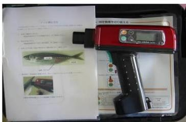
粗脂肪量の非破壊測定装置
