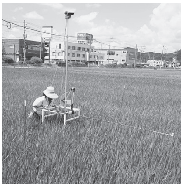
第1図 レーザー式生育センサーを用いたリモートセンシングの様子
