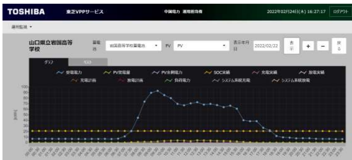
図 2-3-2 受電電力、PV 発電量、蓄電池充放電電力および SOC 等の表示画面
