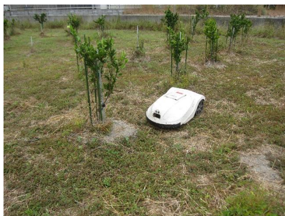
図2 ロボット草刈機の実証試験
