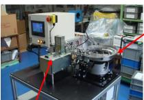
パーツフィーダ 〇リングを投入すると 自動で組み付け装置に 供給される。
