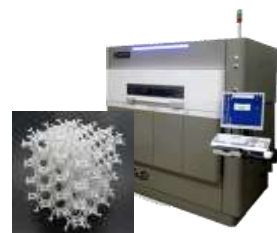
3Dプリンター (粉末焼結式樹脂造形機)
