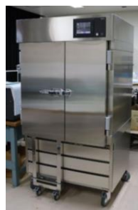
—事業化事例— 再生医療向け細胞組織 冷凍保存用フリーザー
