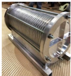
県内企業が開発中の水電解装置（商用機モデル）
