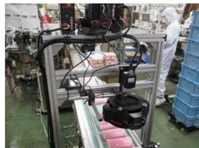
A I を用いた不良品検知システム
