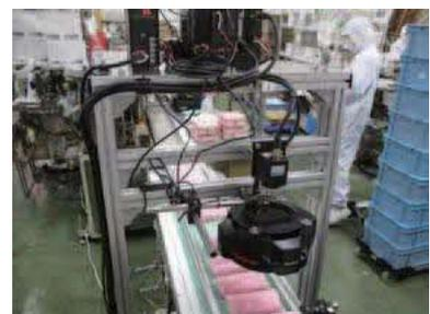
AIを用いた不良品検知システム
