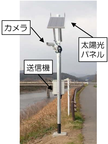
▲河川監視カメラ
