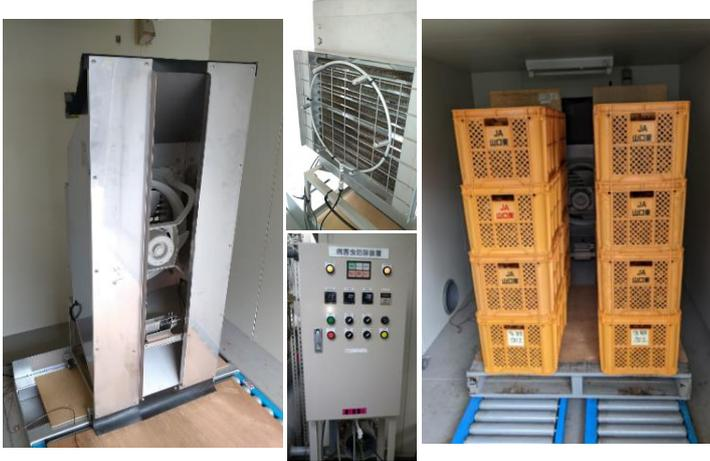
図 1 簡易型蒸熱処理機
