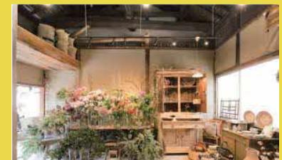
室内は土間にして靴で上がる様にした。もともとの土壁と梁を見るようにし、土壁は崩れないよう処理した。
