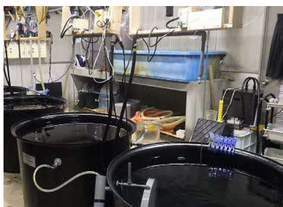
図2 連結式浮遊幼生飼育水槽（シャワー装置、攪拌モーター、循環ポンプが必要）
