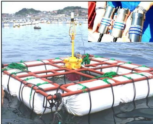
クロロフィルセンサーと設置イカダ
