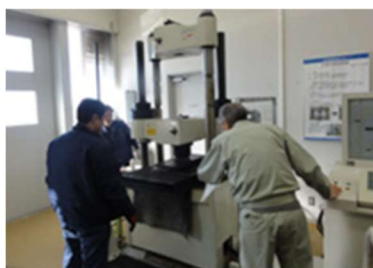
万能材料試験機による強度試験
