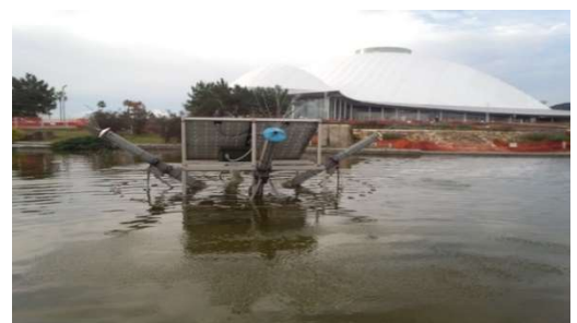
自由支持式螺旋ポンプ（弊社特許技術） 回転軸の向側支持が不要なため設置・撤収が容易に！
