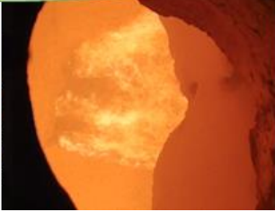
アンモニア混焼実験 (セメントキルン)
