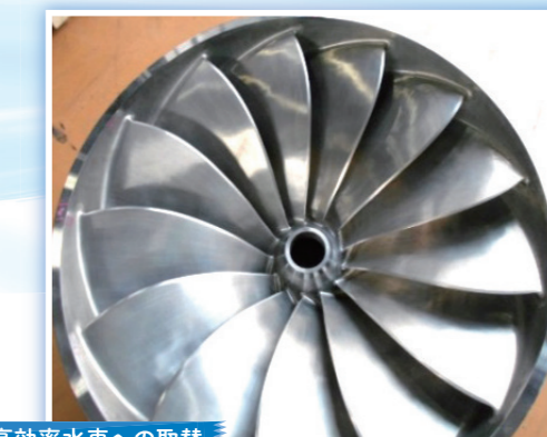
高効率水車への取替
