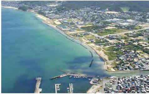
かつての白砂青松の美しい海岸線が昭和40年代から急激に侵食を受けるようになり汀線の後退が深刻化したため、国土保全の観点から侵食対策を行います。良好な景観に配慮し、河川局所管事業で緩傾斜護岸を、港湾局所管事業で、離岸堤（潜堤）、養浜、突堤を整備し、面的防護方式による防護を行います。
