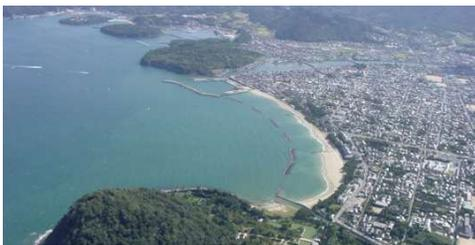
萩市菊ヶ浜地区海岸は、冬季風浪により砂浜の侵食を受けており、レジャーや憩いの場としての利用減少に加え、高潮や津波等に対する防護機能が低下していることから、突堤等の整備や養浜を実施し、面的防護方式による防護を行います。
