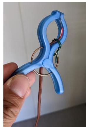
図5 温度センサ固定法
