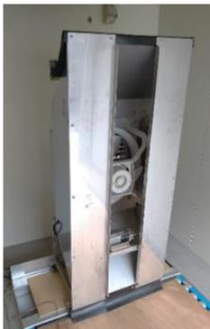
簡易型蒸熱処理機
