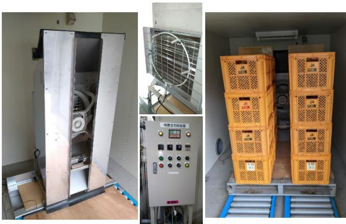
図1 簡易型蒸熱処理機
