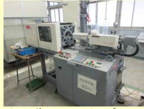
ペットボトルリサイクルプラント 装置による校章入り定規作製
