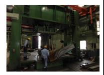
創業140年以上続く船舶の建造及び修繕を基盤に、大型プレス機を600トン・1200トン・1500トン 3基導入しており、鉄板では3.2mm~100mmまでの曲げ加工が可能で、現在では大手・中手の造船所様より、船の船首部や船尾部の船体の中でも一番複雑で難しい部分の鉄板曲げに評価を頂き、九州から関東に至るお客様より「曲げの大田造船」と言われるまでになり、色々なお仕事をさせて頂いております。
