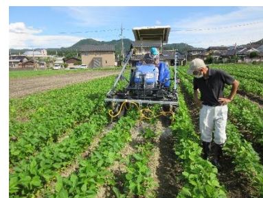
吊り下げノズルによる防除(大豆)
