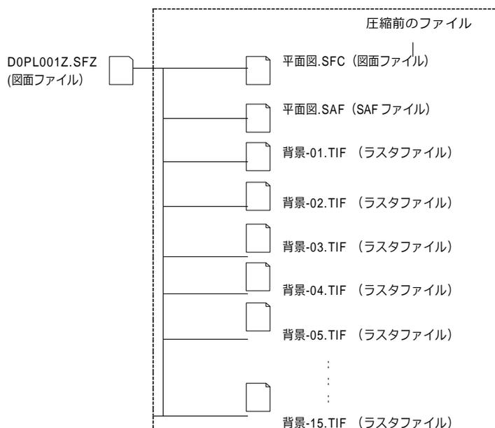
図 5-7 SXF(SFZ)形式のデータ構成例
