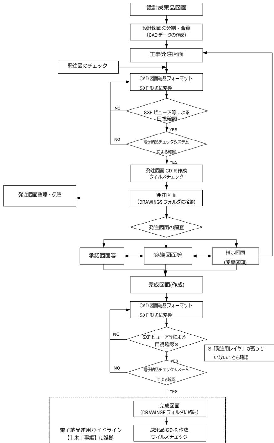
図 7-1 工事における CAD データ成果品の作成手順
