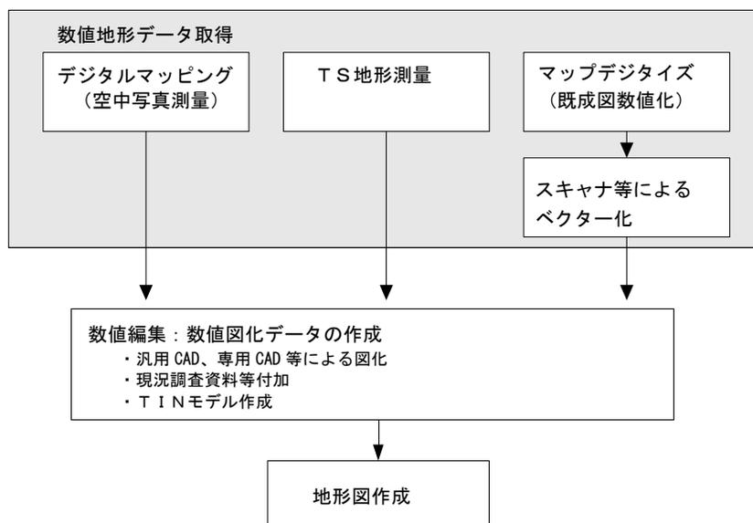
図 5-1 地形図作成までのプロセス
