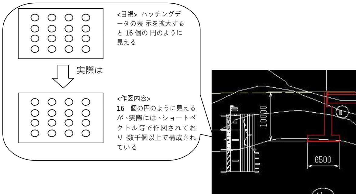
図 2-3 柱状図のハッチング等において多数の要素で描かれている事例およびイメージ図
