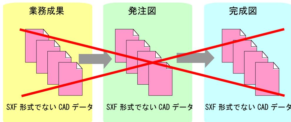
図 8-9 SXF (SFC) 形式以外の CAD データを完成図で利用
