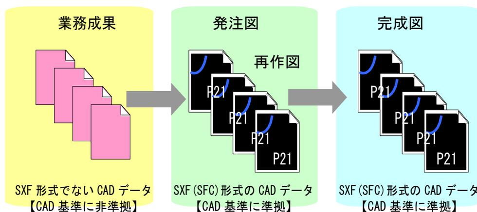
図 8-8 CAD 基準に準拠していない SXF (SFC) 形式以外の CAD データを発注図で再作図して SXF (SFC) 形式
