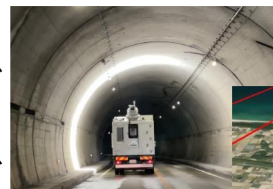
走行型 トンネル点検車
