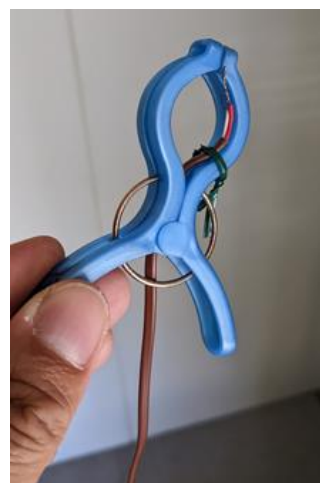
図5 大型クリップに固定した温度センサー
