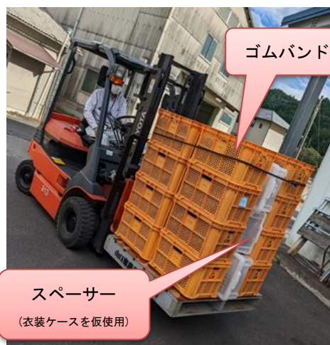
図4 コンテナのパレット輸送試験の様子
