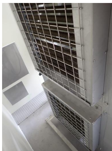
図6 改良型蒸熱処理機(左:全体。連装化した吸気ファンが見える(矢印)。右:連装化したヒーター(裏面))
