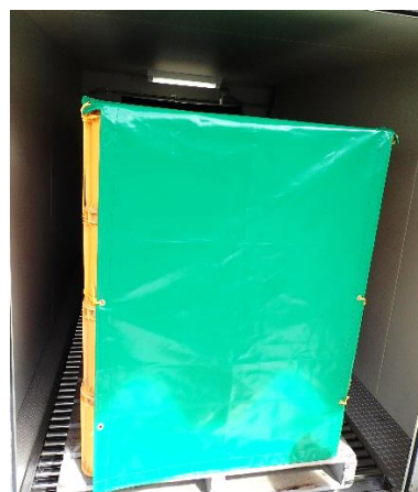
図9 通風に影響しないスケルトン型スパーサー(上)、熱気の通気方向を側面に限定するためのシート(下)
