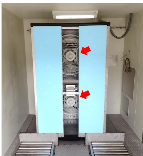
図6 改良型蒸熱処理機(左:全体。連装化した吸気ファンが見える(矢印)。右:連装化したヒーター(裏面))
