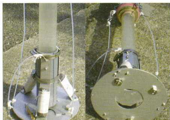
図3 採取泥流防止用シャッター装置
