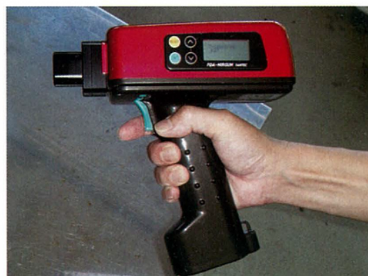
写真1 ハンディタイプ近赤外分光分析器 （FQA-NIRGUN）
