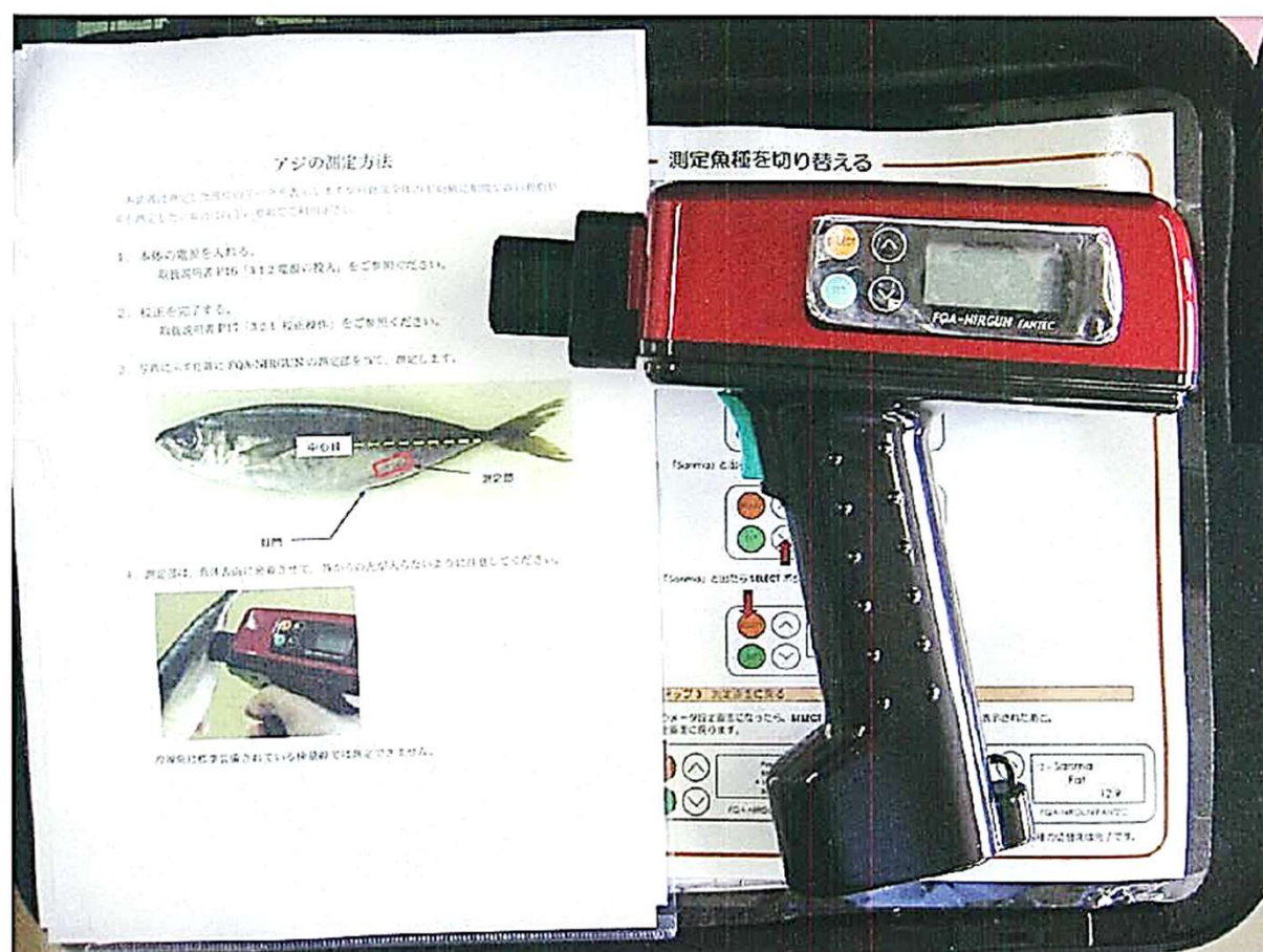
写真1 リアルタイム脂質含量測定装置
