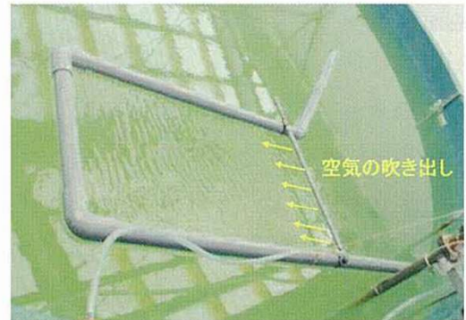
図3 試験に使用した油膜除去装置（空気を矢印の方向に吹き付けて水面の油膜を集めます）
