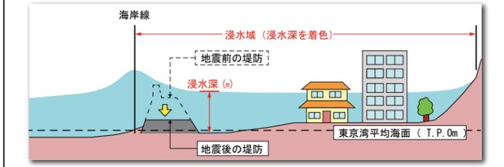
地域によっては、地震により堤防等が破壊され、津波が襲来する前に浸水が始まる場合があります。
