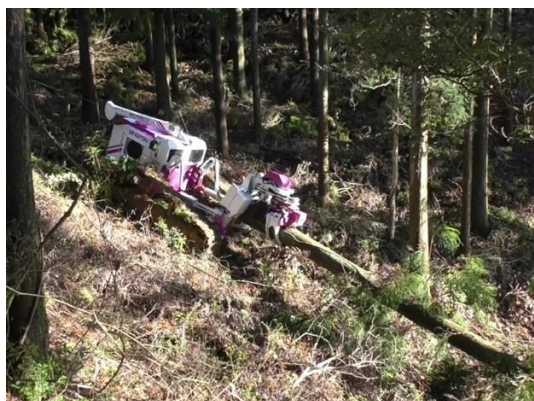
図9 ラジコン式伐倒作業車
