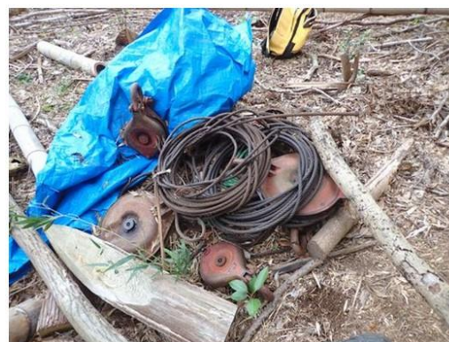
図14 ドローン運搬架設器具（約20kg/個）
