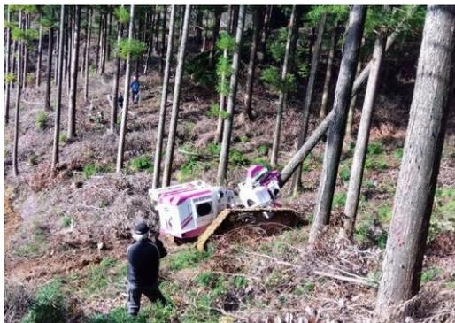
図7 ラジコン式伐倒作業車の伐倒
