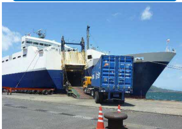
RORO船の荷役状況
