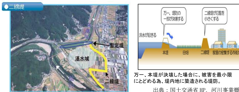
図 3.3.20 二線堤による氾濫防御のイメージ
