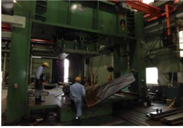
大田造船の最大の強みは、「人の手でしかできない仕事」があることです。プレス機でぎっくりと曲げた鉄板を、バーナーで焼きながらミリ単位の誤差も出さず手作業で仕上げていく—これが私たちの“曲げ加工”です。船の船首部や船尾部の船体の中でも一番複雑で難しい部分の鉄板曲げに評価を頂き、お客様より「曲げの大田造船」と言われるまでになりました。この仕事には温度計も機械も使いません。鉄の色や音、手に伝わる感触から「今どのくらいの温度か」「どう曲げるか」を感じ取る、まさに“職人の感覚”がすべての世界。だからこそ、時間をかけてしっかりと教え、一人ひとりが職人として一人前になるまで、丁寧に育てていきます。ほかでは経験できない、唯一無二の技術。そして自分の手で形をつくり、それが海を走る大きな船の一部になる—そんなダイナミックなものづくりに関わることができるのが、私たちの仕事です。
