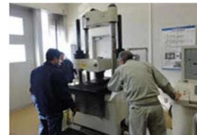
万能材料試験機による強度試験
