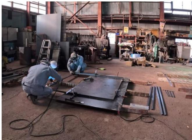
わな枠を鋼材で組立（底面）
