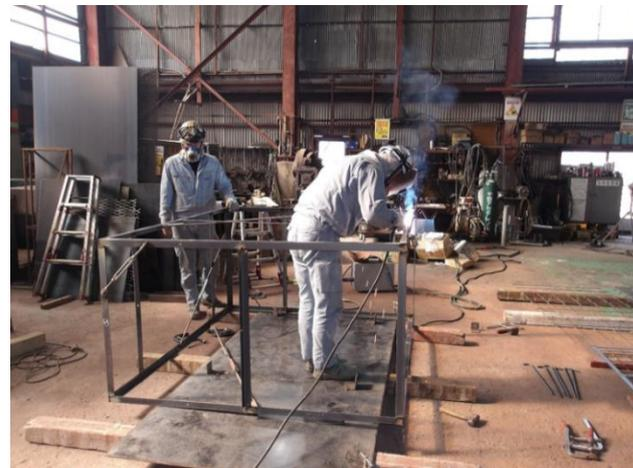
ワナ枠の補強 FB の設置
