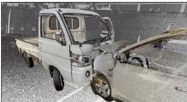
【3Dデータによる事故状況の再現】
